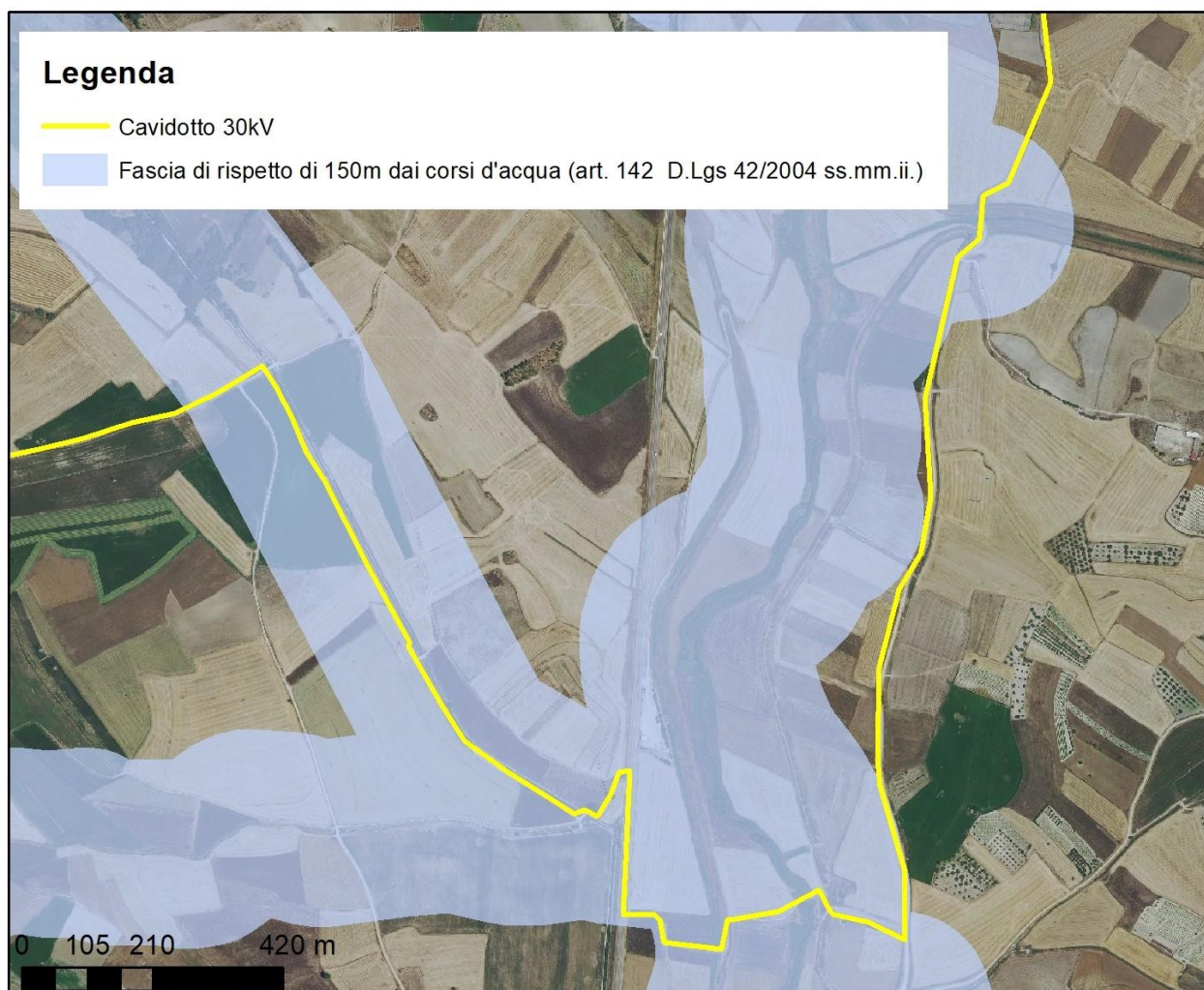
Figura 3.2 – Sovrapposizione del cavidotto 30kV ivi impostato su viabilità esistente con la fascia di tutela paesaggistica di 150m dei corsi d'acqua "Funtana Su Conti", "Flumini Mannu_041", "Riu de Su Pauli"
