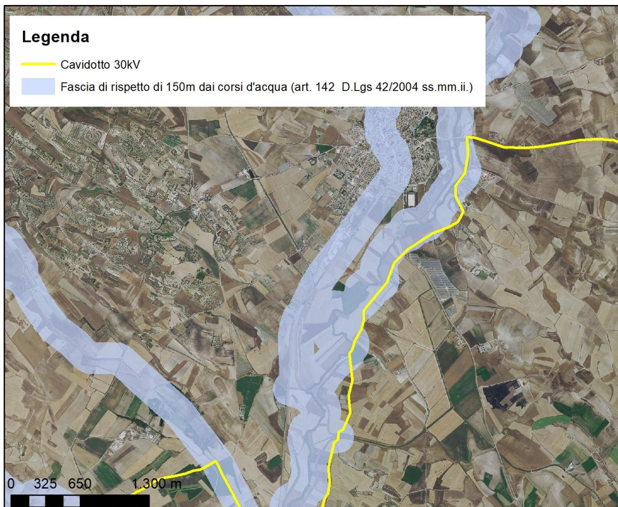
Figura 3.3 - Sovrapposizione del cavidotto 30kV ivi impostato su viabilità esistente con la fascia di tutela paesaggistica di 150m del "Flumini Mannu_041"
