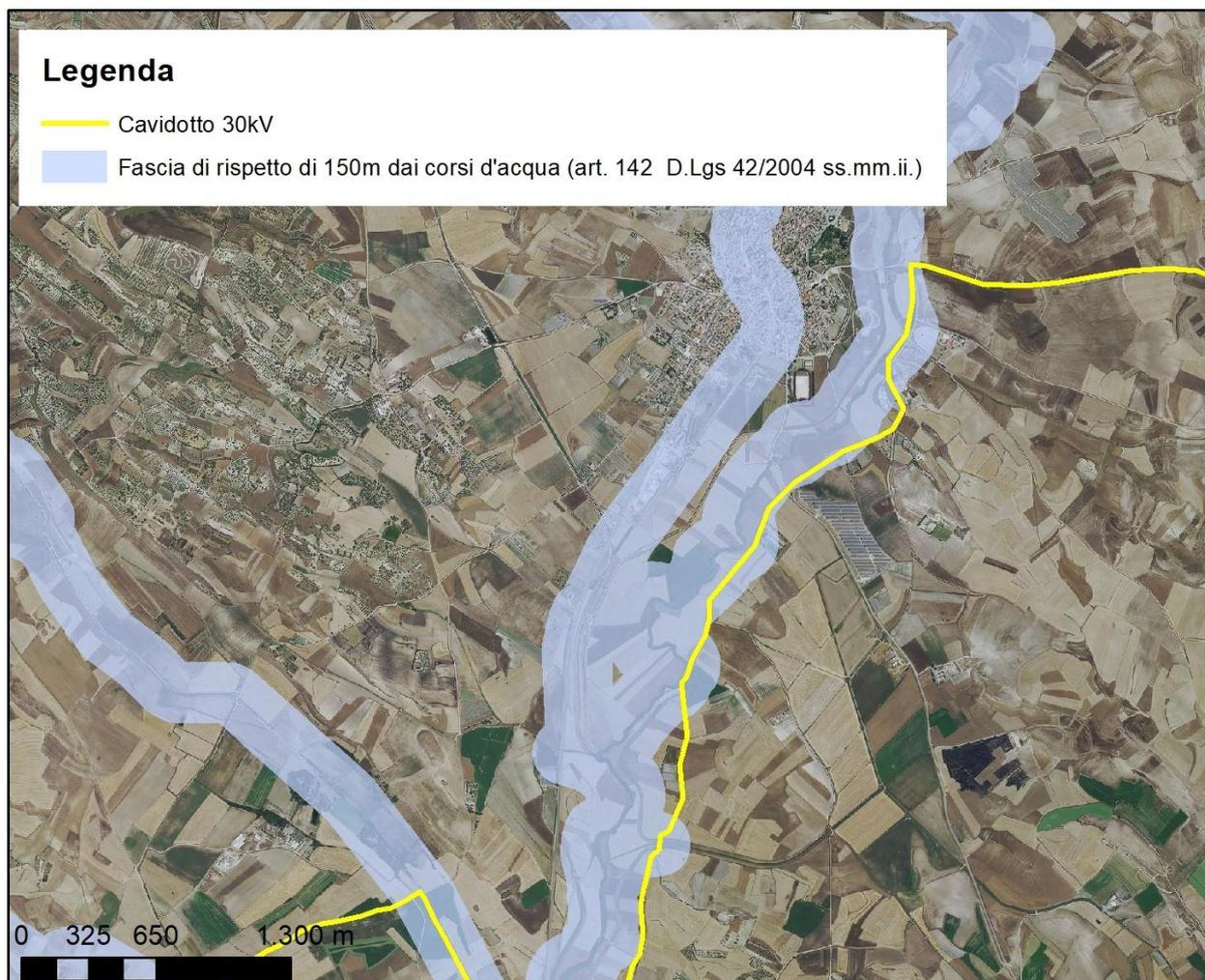
*Figura 6.3\_Sovrapposizione del cavidotto 30kV ivi impostato su viabilità esistente con la fascia di tutela paesaggistica di 150m del "Flumini Mannu\_041"*
