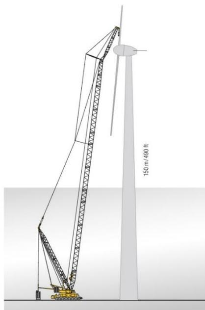
*Figura 5.4\_Schema di una gru cingolata a traliccio con sistema derrick impiegata per l'innalzamento delle turbine eoliche dell'ultima generazione*
