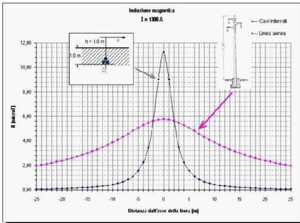
Figura 2 - Attenuazione dell'induzione magnetica dovuta all'interramento dei cavi
