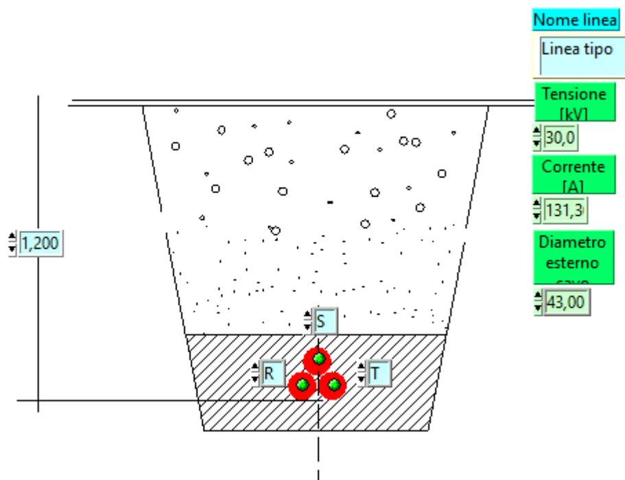
Figura 3 – Sezione tipo cavo MT
