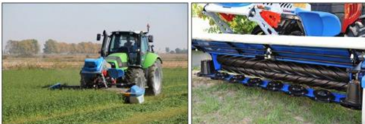
Esempio di falciacondizionatrice frontale e particolare dei rulli in gomma
