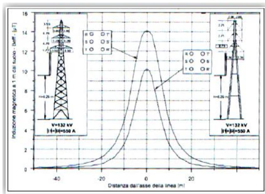
Dalle due figure seguenti si nota come anche l'allineamento dei conduttori, da orizzontale a verticale, riesca a ridurre l'induzione di campo da 0,85  $\mu\text{T}$  a 0,42  $\mu\text{T}$ .
