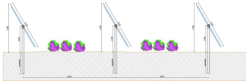
DETTAGLIO SEZIONE LONGITUDINALE STRUTTURA - SCALA 1:100
