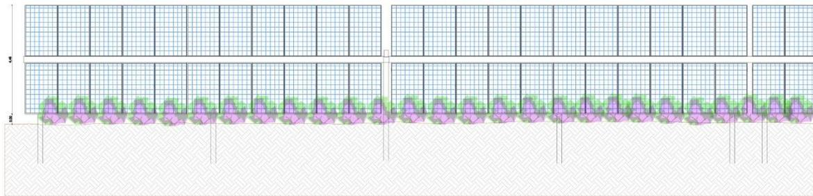
L'inseguitore è costituito essenzialmente da un motore elettrico che tramite un'asta collegata al profilato centrale della struttura di supporto, permette di ruotare la struttura durante la giornata, posizionando i pannelli nella perfetta angolazione per minimizzare la deviazione dall'ortogonalità dei raggi solari incidenti, ed ottenere per ogni cella un surplus di energia fotovoltaica generata.
