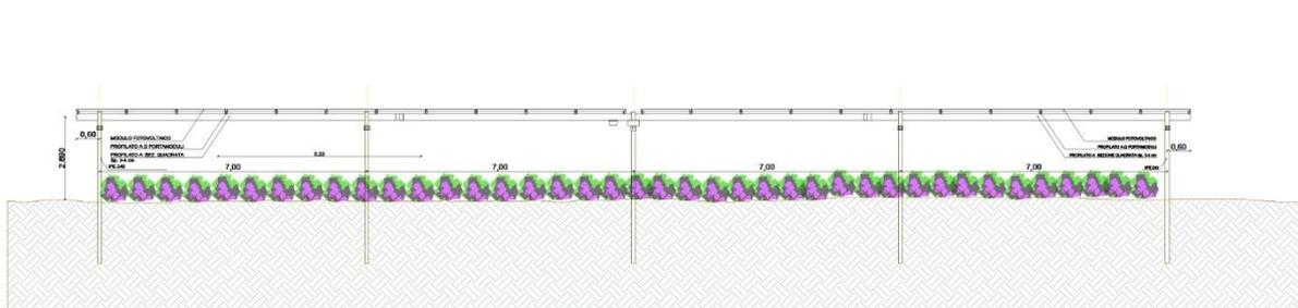
L'altezza dei pali di sostegno è stata fissata in modo tale che lo spazio libero tra il piano campagna ed i moduli, alla massima inclinazione, sia superiore a 0,40 m, per agevolare la fruizione del suolo per le attività agricole. Di conseguenza, l'altezza massima raggiunta dai moduli è di 4.98 m.
