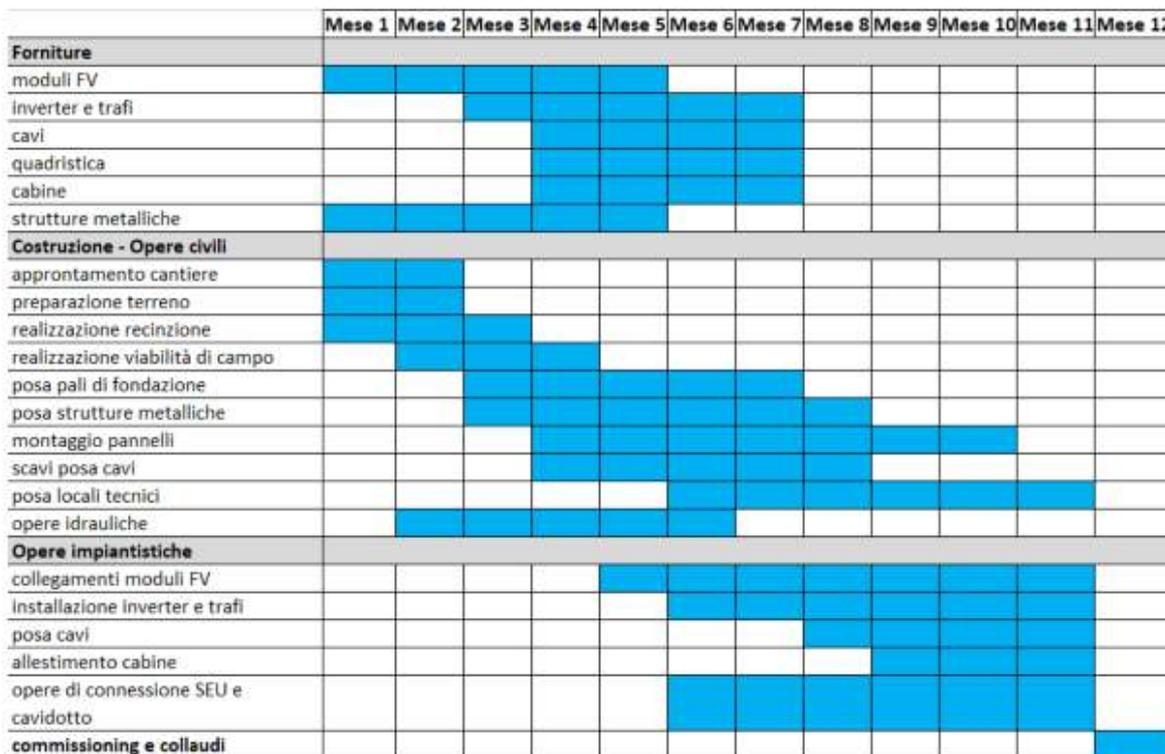
Fig. 8\_Cronoprogramma di cantiere
