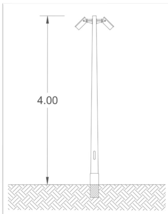
*Figura 20: sostegno per impianto di videosorveglianza*
