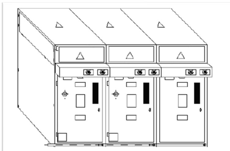
*Figura 16: immagine indicativa quadro elettrico 36 kV isolato in aria*
