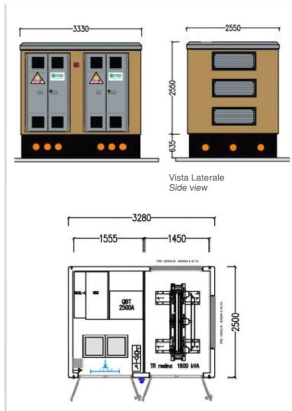
Figura 19: Costruttivo Cabine Servizi Ausiliari
