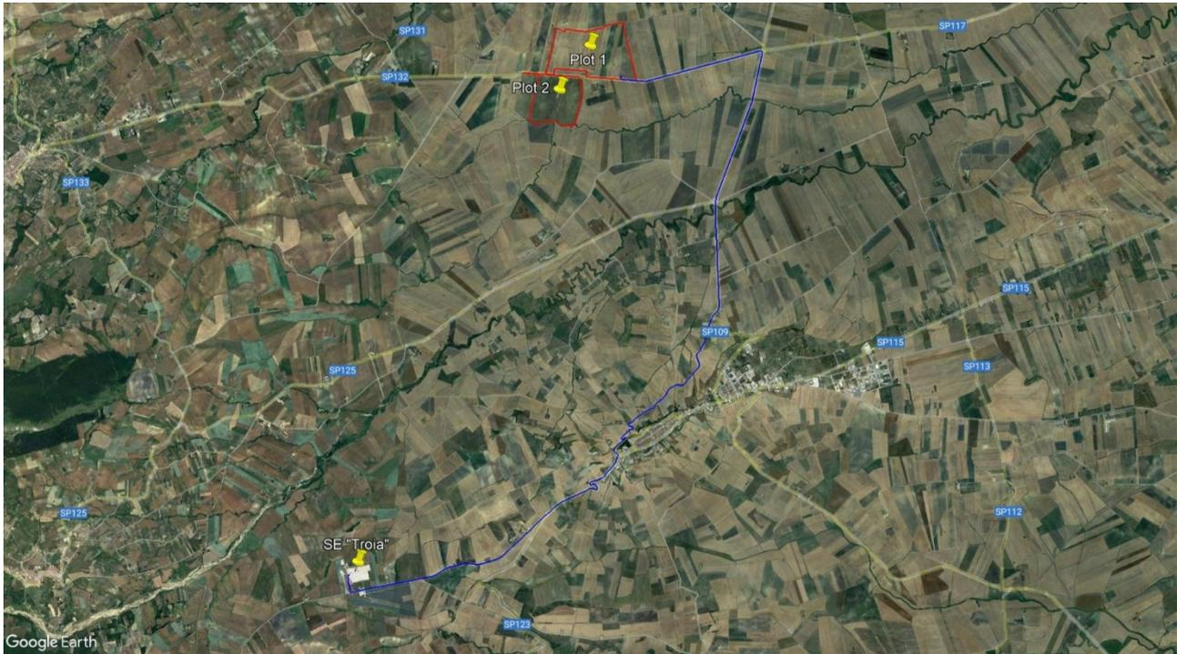
*Figura 8: inquadratura territoriale su ortofoto dell'area di impianto con indicazione del tracciato della dorsale a 36 kV di collegamento con la Stazione Elettrica di Trasformazione della RTN denominata Troia*
