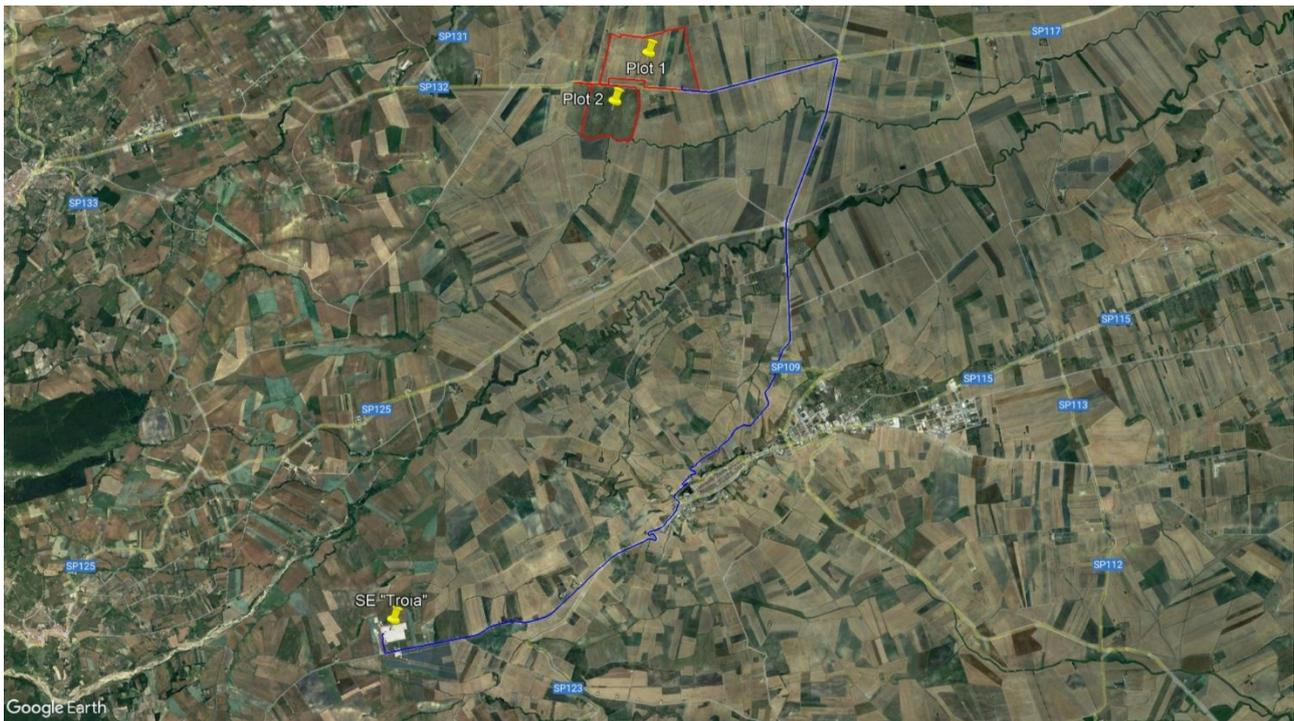
**Figura 3: inquadratura territoriale su ortofoto dell'area di impianto con indicazione del tracciato della dorsale a 36 kV di collegamento con la Stazione Elettrica di Trasformazione della RTN denominata Troia**
