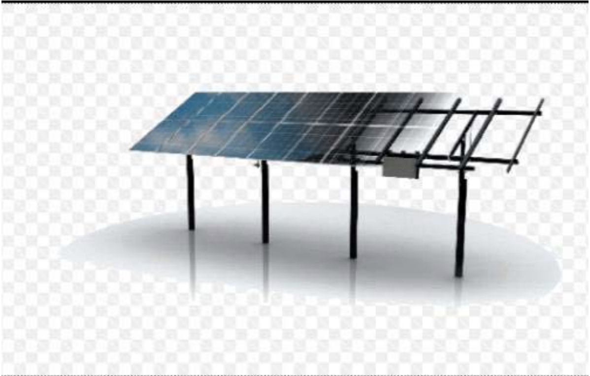
Figura6: Rappresentazione della struttura di supporto
