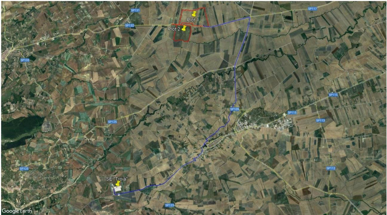
**Figura 2: inquadramento territoriale su ortofoto dell'area di impianto, con indicazione del tracciato della dorsale a 36 kV di collegamento la Stazione Elettrica di Trasformazione della RTN denominata Troia**
