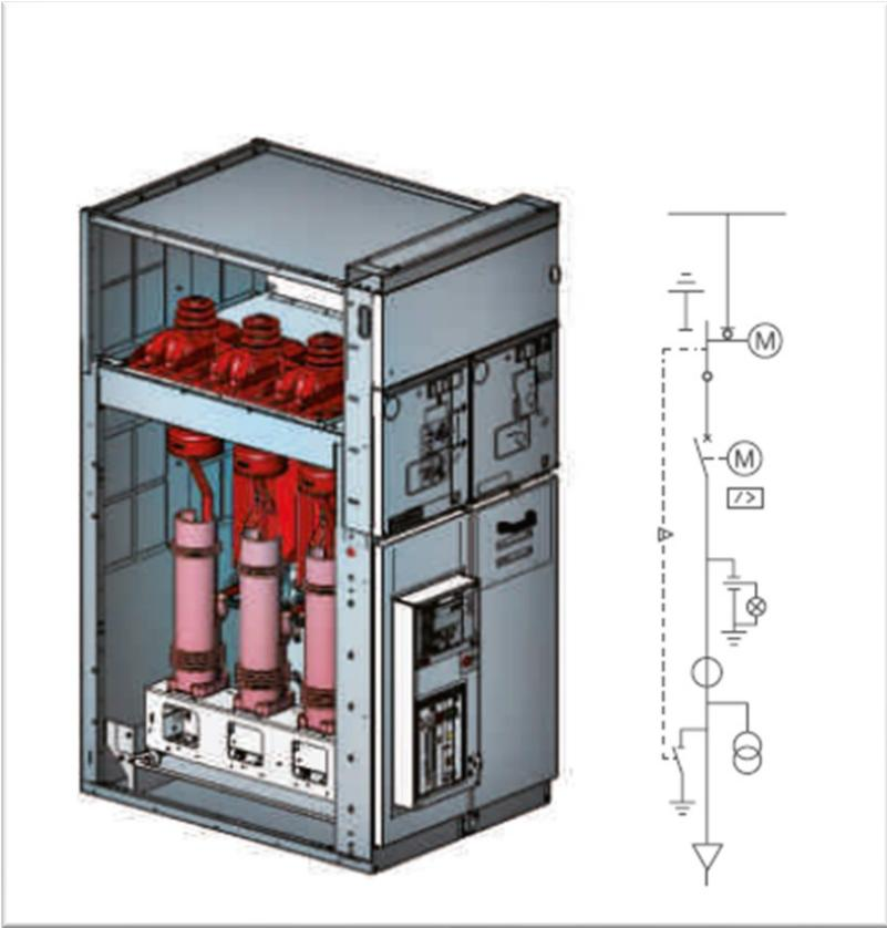
*Figura 10: scomparto protezione trasformatore*
