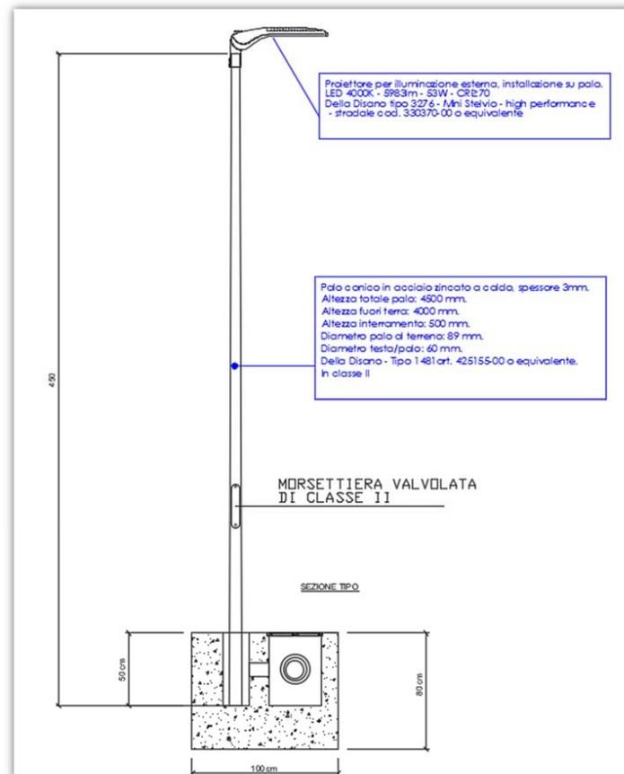
**Figura 19: apparecchio illuminante scelto in fase di progettazione definitiva per realizzare l'impianto di illuminazione perimetrale**
