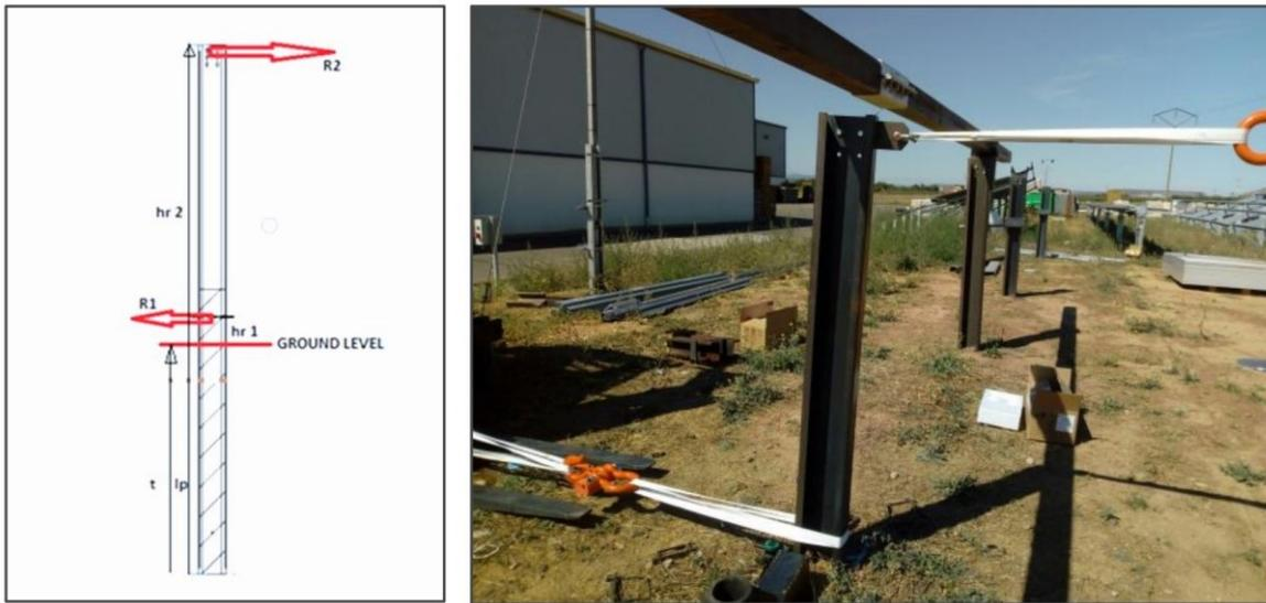
Figura 5 - esempio posizionamento pali infissi
