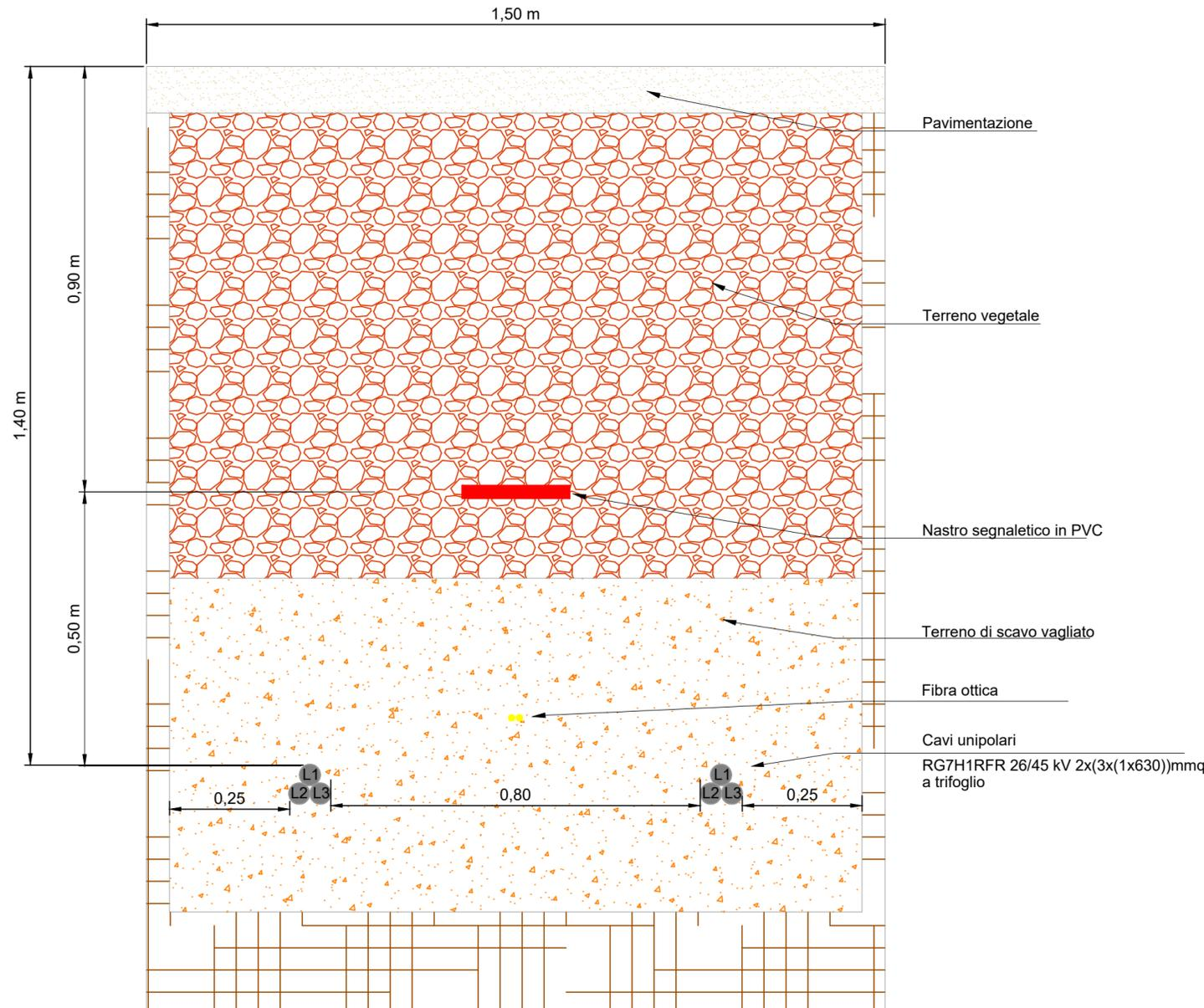
LINEA A 36 kV DI COLLEGAMENTO CON LA SE TERNA
