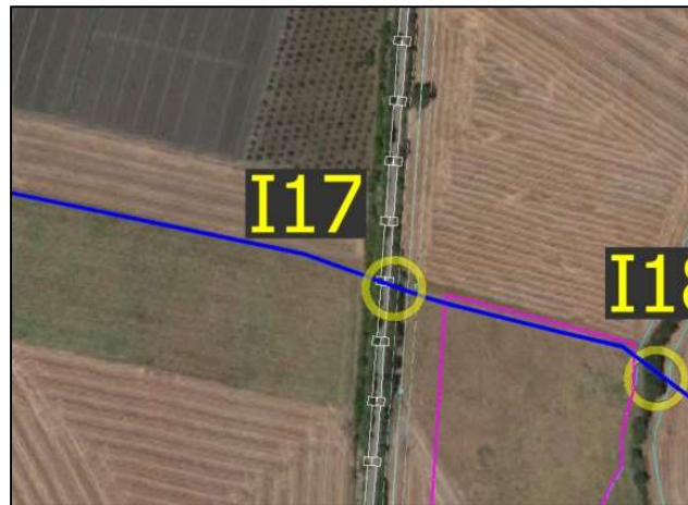
Figura 39: Inquadratura su ortofoto dell'interferenza I17 con la rete ferroviaria
