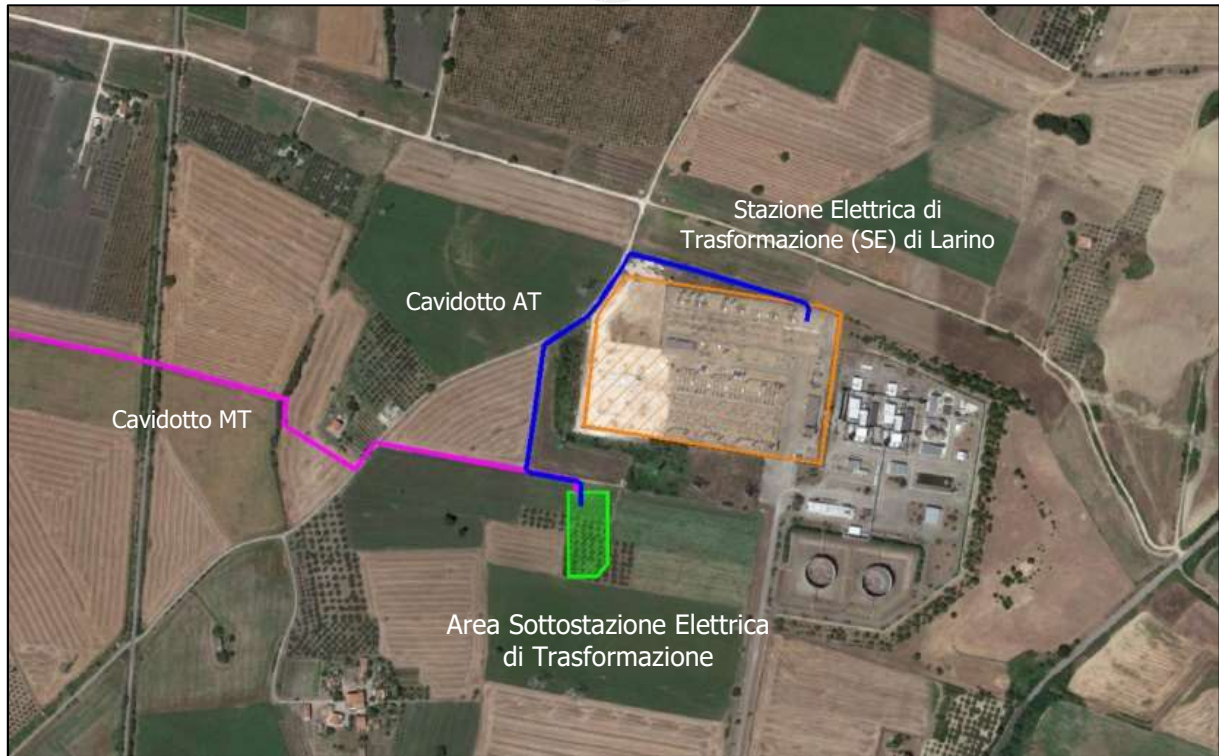
Figura 2: Inquadramento su ortofoto dell'area occupata dalla SSE
