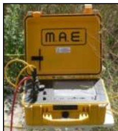
Fig. 2: sismografo multicanale M.A.E. modello A 6000 S.
