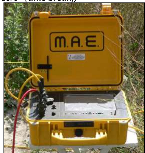
Fig. 3: sismografo multicanale M.A.E. modello A 6000 S. PAGINA 9 di 136
