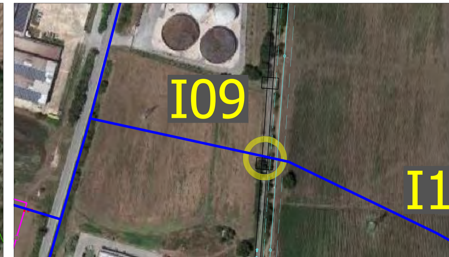
Interferenza I09: attraversamento ferrovia Termoli-Campobasso e condotta Consorzio di Bonifica. Base su ortofoto in scala 1:2000
