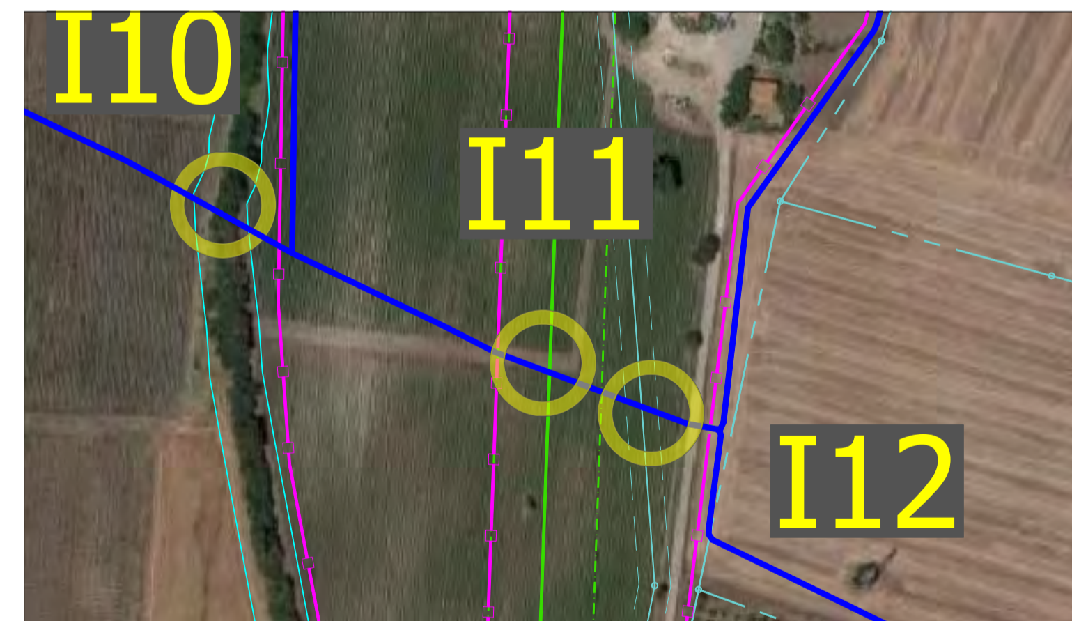
Interferenza I11: attraversamento metanodotto. Base su ortofoto in scala 1:2000
