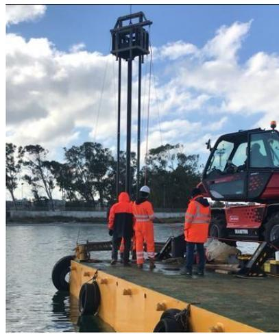
Foto 11: Sondaggio a mare vibrocarotiere
