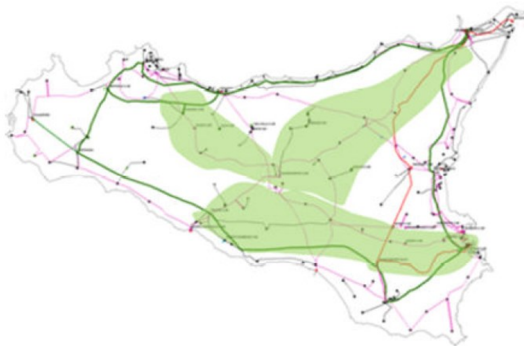
Figura 31. Estratto PEARS 2030. Figura 51: Principali aree di intervento per favorire la produzione da FER sulla rete AT
