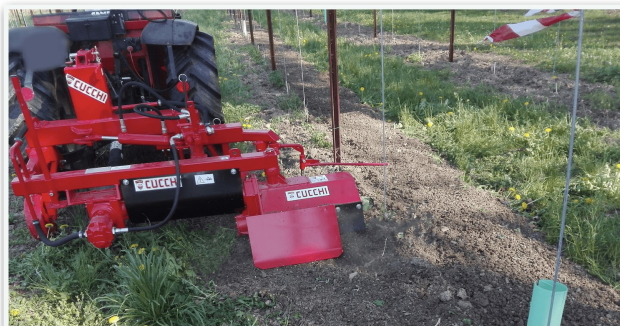
Figura 8 - Esempio di macchina operatrice con fresa interfilare per la lavorazione e lo sfalcio delle aree al sotto dei pannelli.
