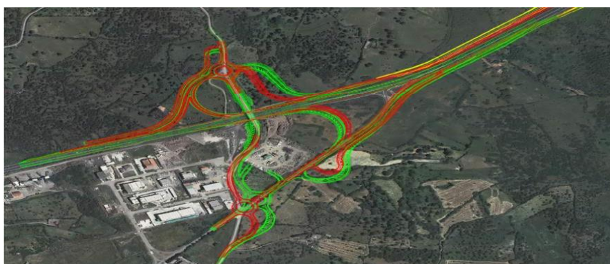
Figura 1 – Nuovo svincolo di Paulilatino – Sovrapposizione PD/PE (in rosso il tracciato PD e in verde quello PE)
