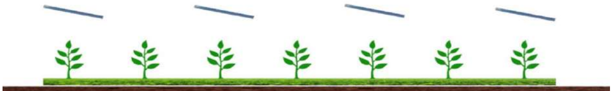
Sistema agrivoltaico in cui la coltivazione avviene tra le file dei moduli fotovoltaici, e sotto a essi (TIPO 1).
