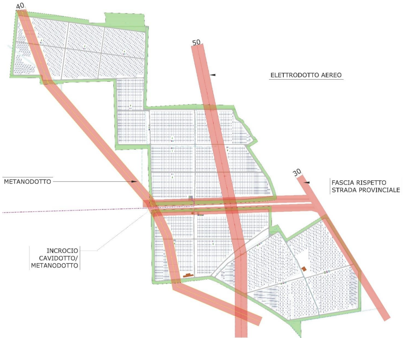
Interferenze interne all'impianto nel Campo 1 Nord
