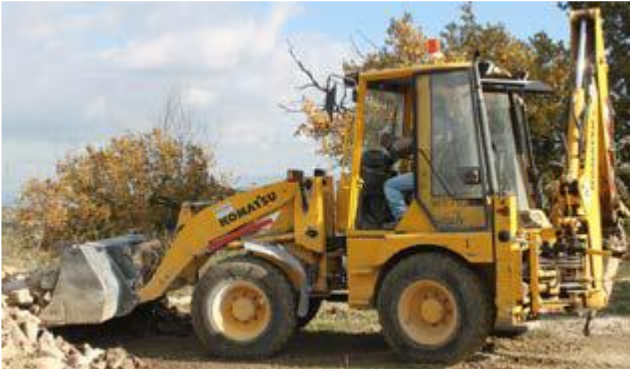
Escavatore caricatore (Terna)
