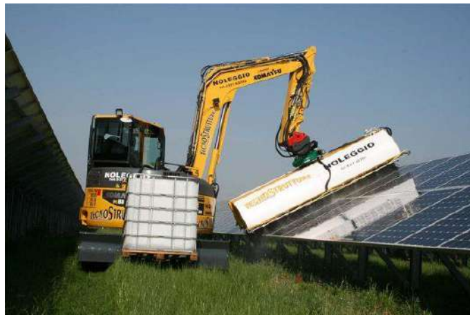
Esempio di sistema di lavaggio moduli fotovoltaici
