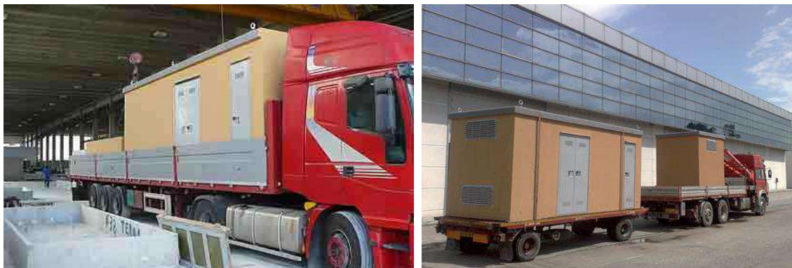
Trasporto cabine elettriche da parte di autocarri con gru
