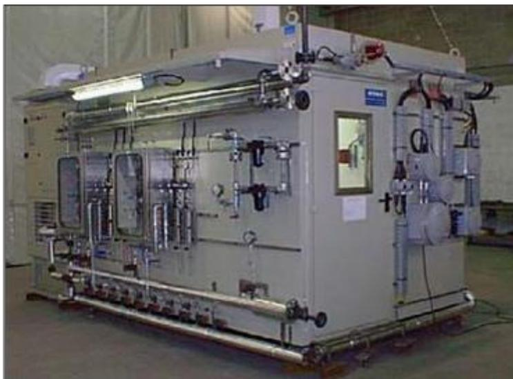
**Figura 39** - Skid Sistema di analisi – Cabina cromatografi
