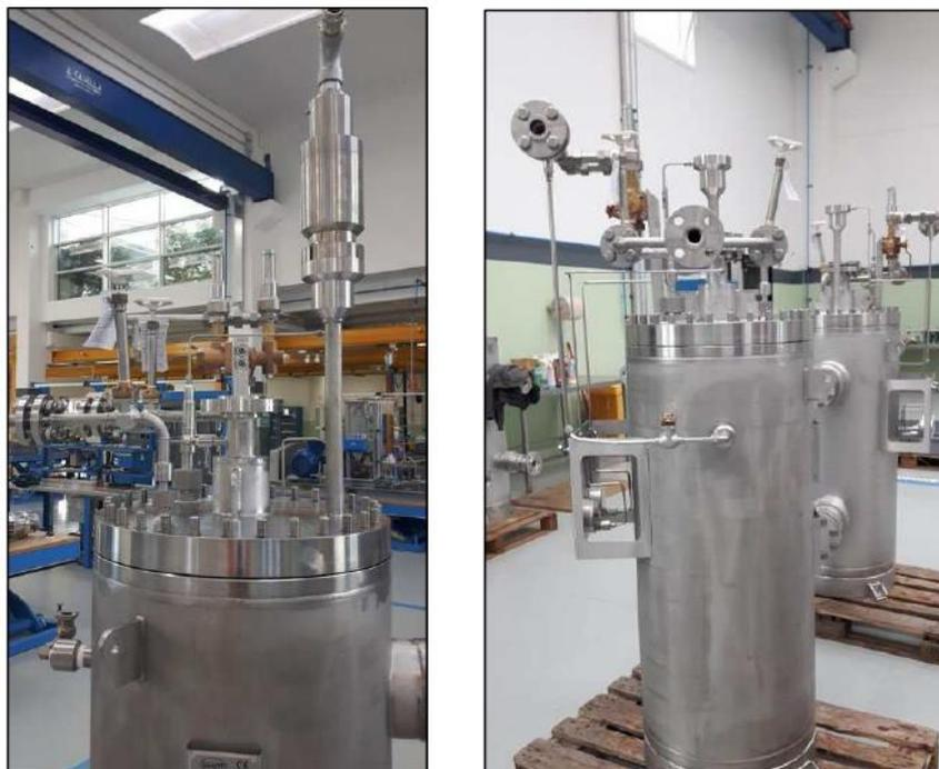
**Figura 29** - Particolare assemblamento criostato
