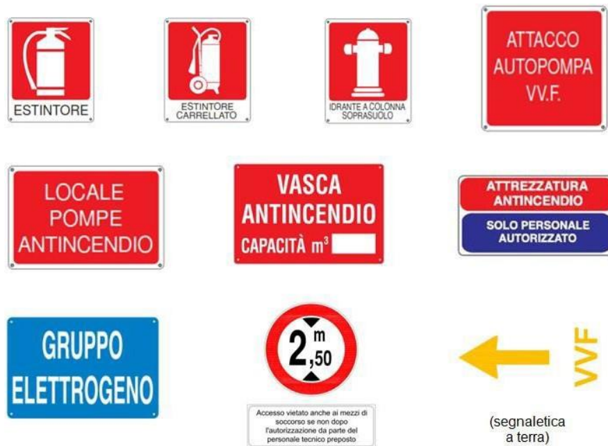
Figura 3 - Esempi di segnaletica di sicurezza
