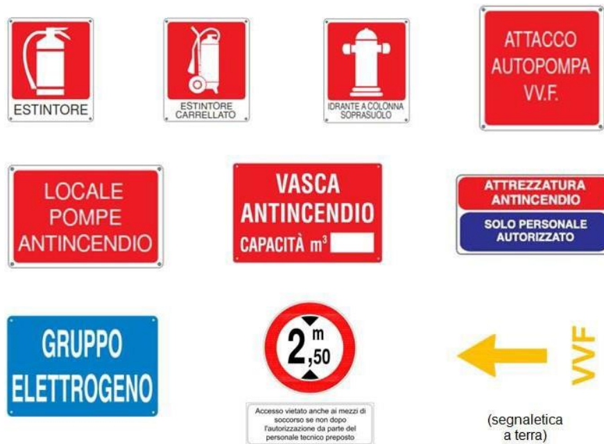
Figura 6 - Esempi di segnaletica di sicurezza
