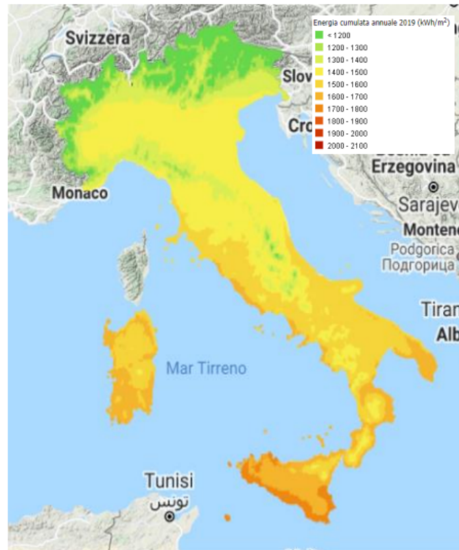
Fig. 6: Radiazione solare cumulata annua del 2020; elaborazione a cura di RSE su dati EUMETSAT ( http://sunrise.rse-web.it/ )
