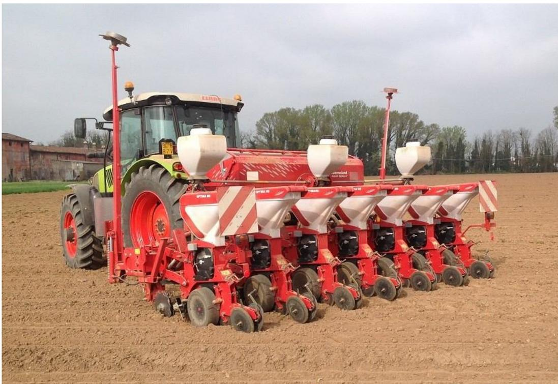
*Foto n.8. Tipologia seminatrice di precisione da impiegarsi nella semina delle colture foraggere*
