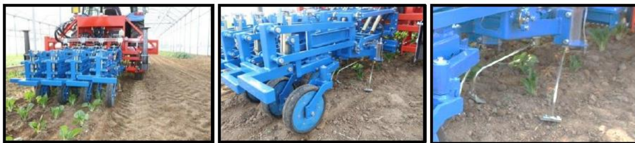
Figura 6.9: Immagine della sarchiatrice funzionante a raggi infrarossi
