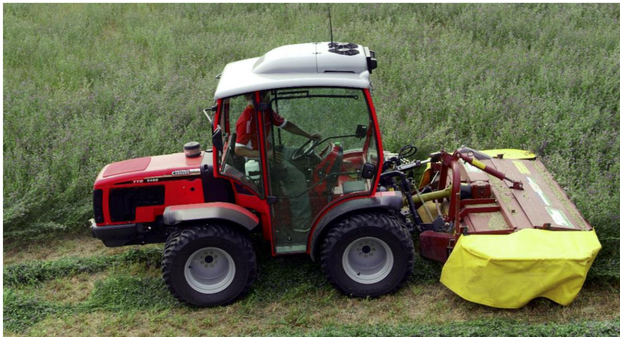
Figura 6.20: Esempio di falciacondizionatrice interceppo posteriore (Foto: Bellon)
