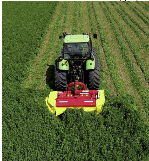
Figura 6.20: Esempio di falciacondizionatrice interceppo posteriore (Foto: Bellon)
