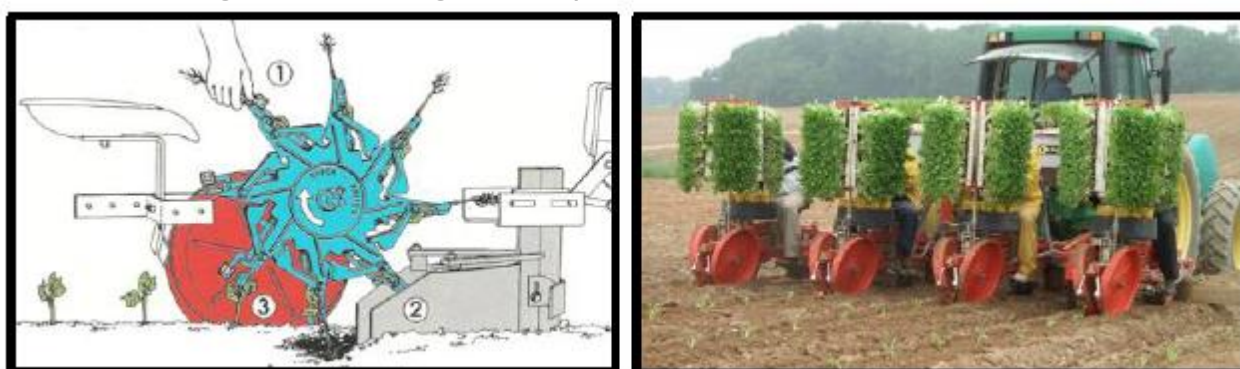
Figura 6.8: Immagine di trapianto con sistema semi-automatico
