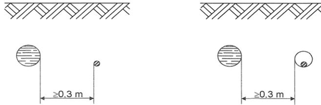
**5.9.4 Incroci e parallelismi tra cavi di energia in tubazione e tubazioni di gas con densità non superiore a 0,8 non drenate con pressione massima di esercizio >5 Bar**
