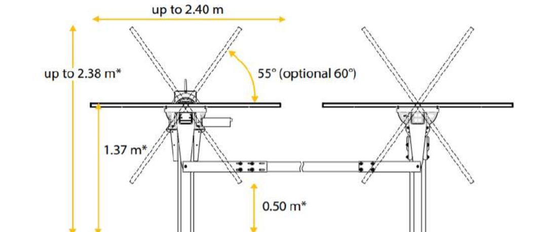
Sono costituite da un montante verticale in acciaio zincato da una testata di supporto alla fondazione su cui vengono installati gli attuatori lineari e gli arcarecci in alluminio orizzontali su cui vengono posizionati i moduli.
