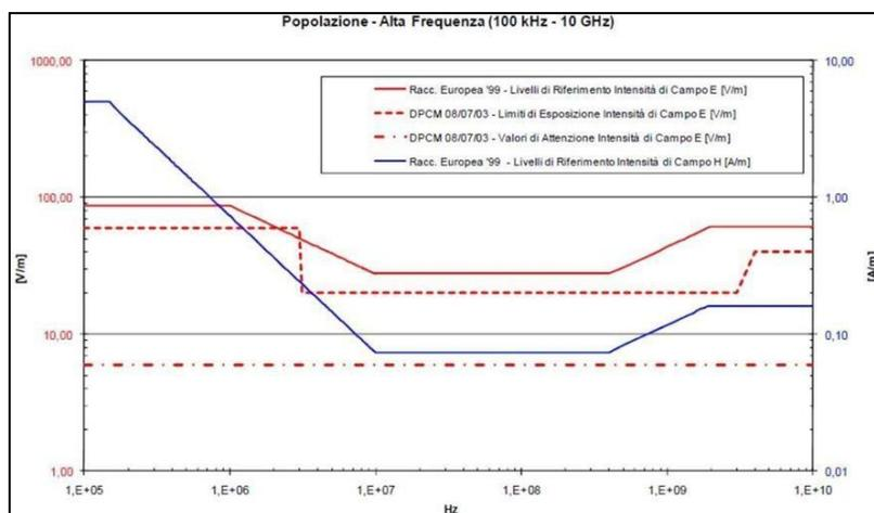
Figura 5. – Livelli esposizione Alta Frequenza (100Hz – 10 GHz).
