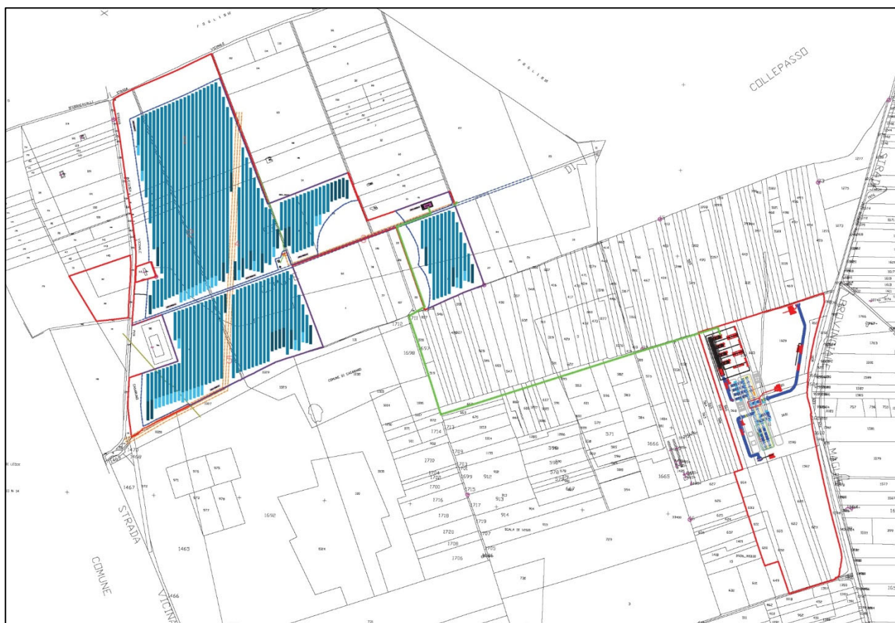
Figura 33 - layout di impianto su base catastale
