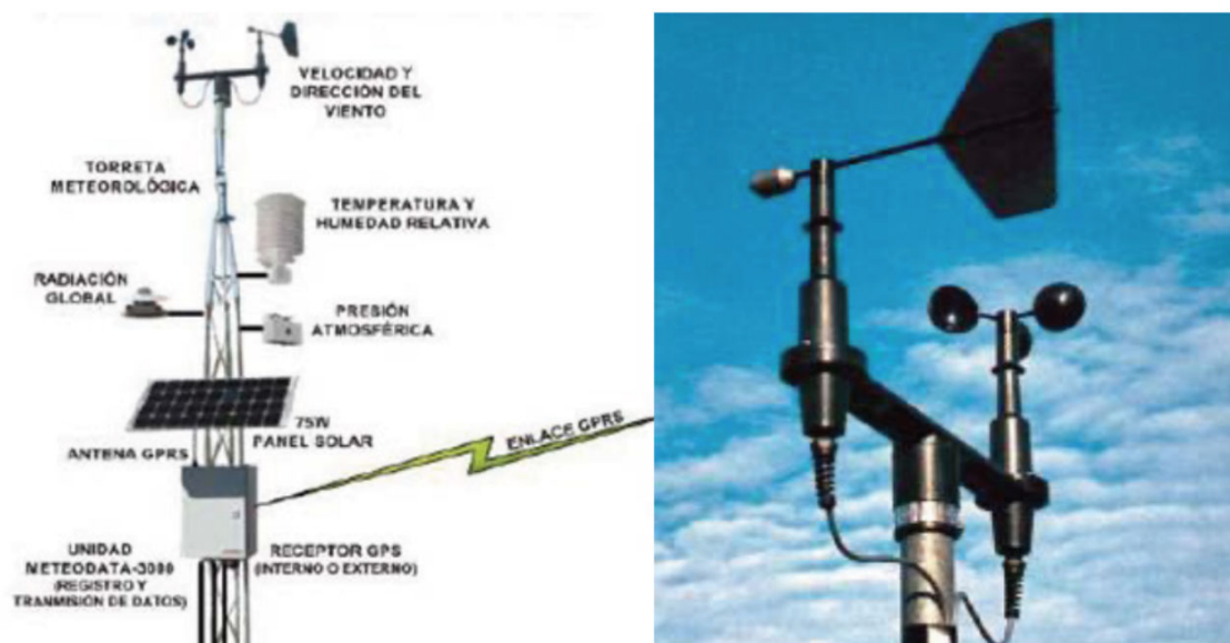
Figura 9 – esempio di stazione meteorologica
