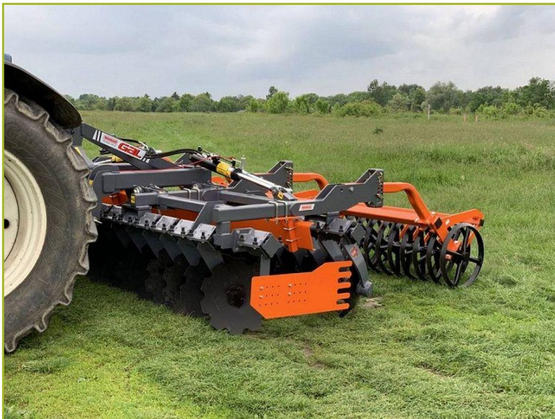
Figura 31 – Frangizolle a dischi utilizzato per la minima lavorazione.
