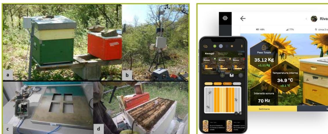
Figura 38 – In alto, esempio di un apiario dotato di bilancia e sensori installati (a), stazione meteorologica in prossimità dell'apiario (b), bilancia pesa arnia (c), sensori umidità e temperatura posizionati internamente all'arnia (d). In basso, dispositivo per la visualizzazione ed il monitoraggio da remoto dei dati raccolti.
