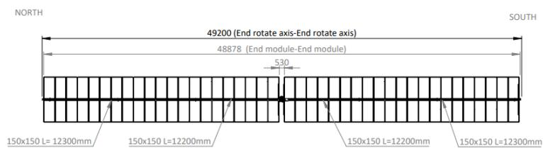
Sono costituite da un montante verticale in acciaio zincato da una testata di supporto alla fondazione su cui vengono installati gli attuatori lineari e gli arcarecci in alluminio orizzontali su cui vengono posizionati i moduli.
