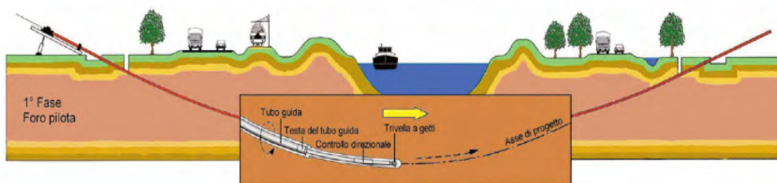
FASE REALIZZAZIONE FORO PILOTA
