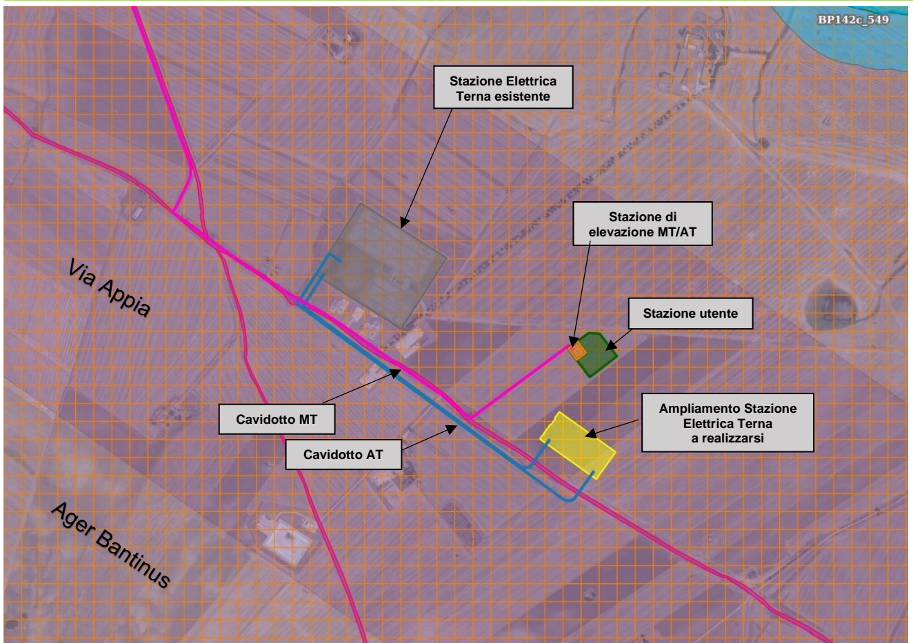
Stazione Terna esistente, ampliamento stazione elettrica, stazione utente e cabina di elevazione su PPR - RSDI Basilicata
