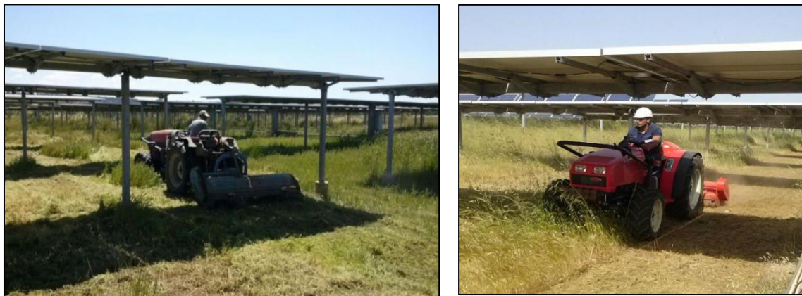
Movimentazione di mezzi agricoli sotto i Tracker
