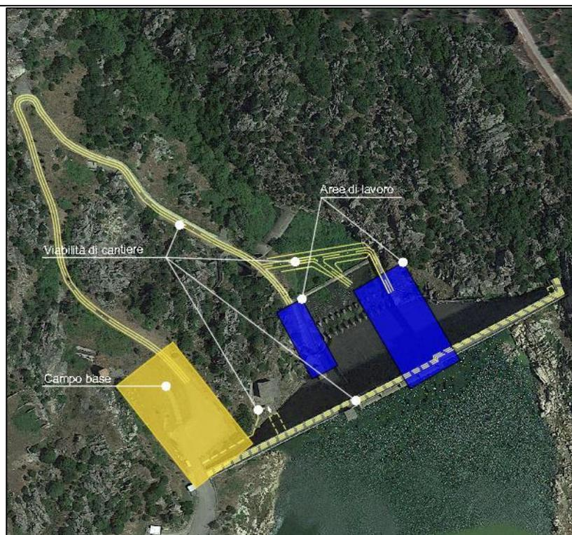
Figura 8 – Schema di cantierizzazione esterna.
