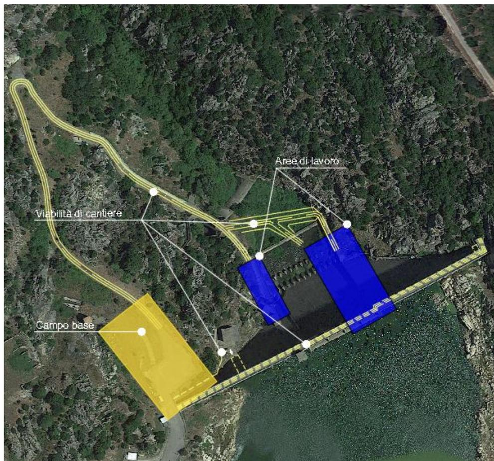
Figura 2 – Schema di cantierizzazione esterna
