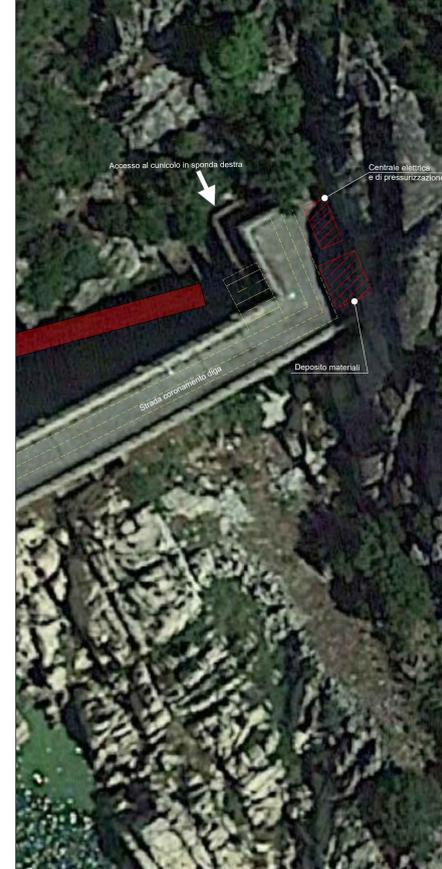
Cantierizzazione zona di valle con accessi al piazzale in destra e alla vasca di dissipazione. Scala 1:200
