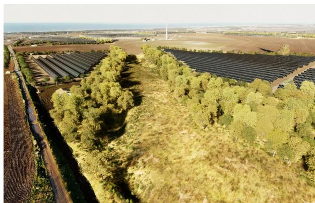
*Figura 8. Stato di progetto, particolare di zona di compensazione a prateria e bosco. Mitigazione intorno agli impianti.*
