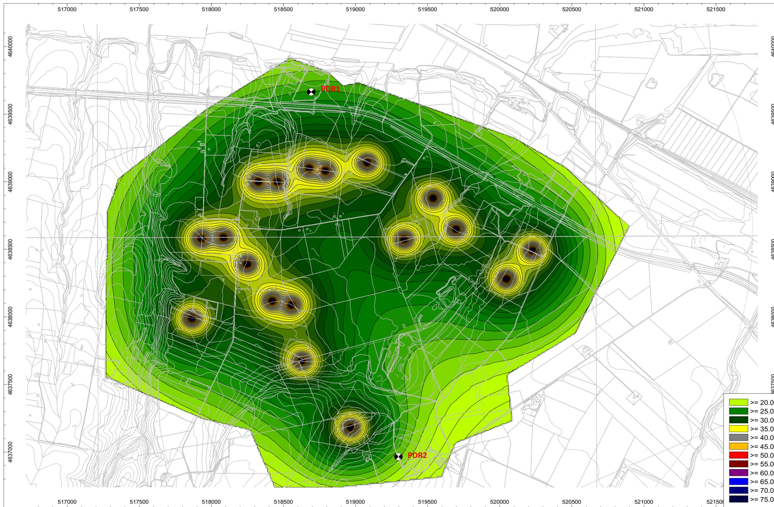
Figura 14 - Mappa previsionale di impatto acustico della sola componente sorgente (TRASFORMATORE + INVERTER)
