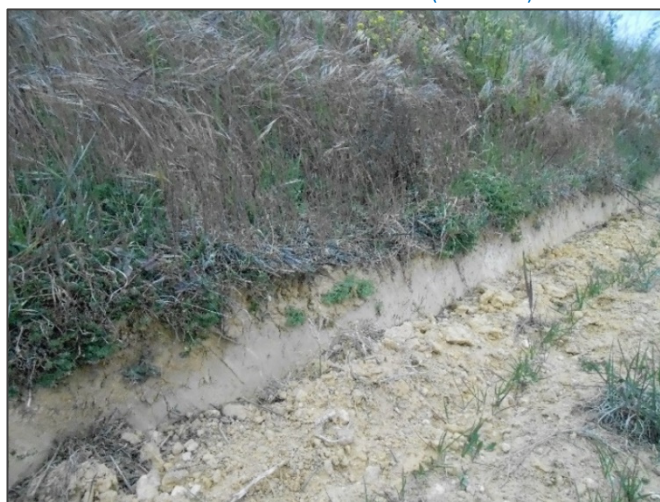
Figura 4.2: visibili in sezione sabbie fini di colore giallastro (area 2)
