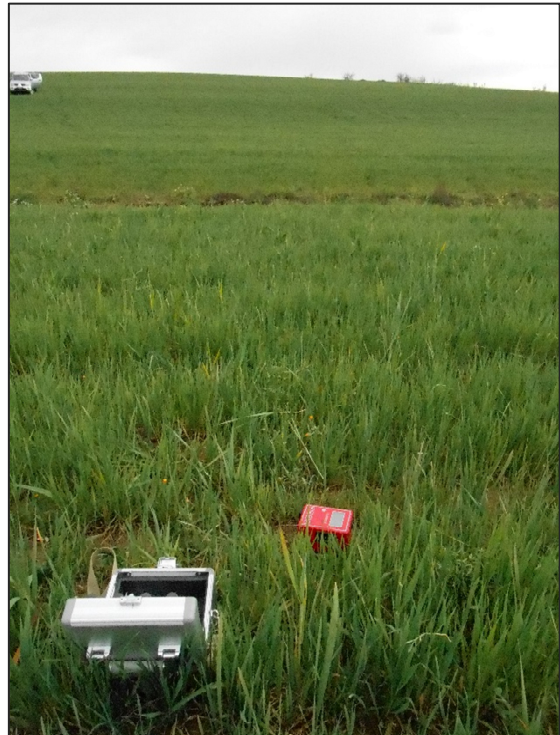
TR3 e TR4: Acquisizione sismica effettuata nell'area interessata dall'impianto
