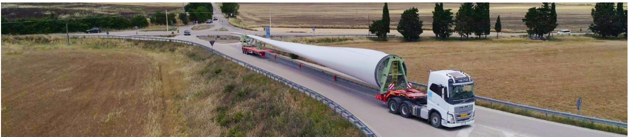
Figura 22 – Esempio di trasporto con SWC (Super Wing Carrier)
