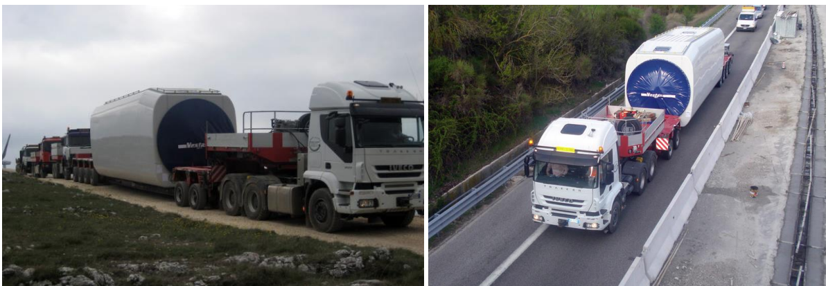
Figura 26 – Esempio di trasporto Nacelle
