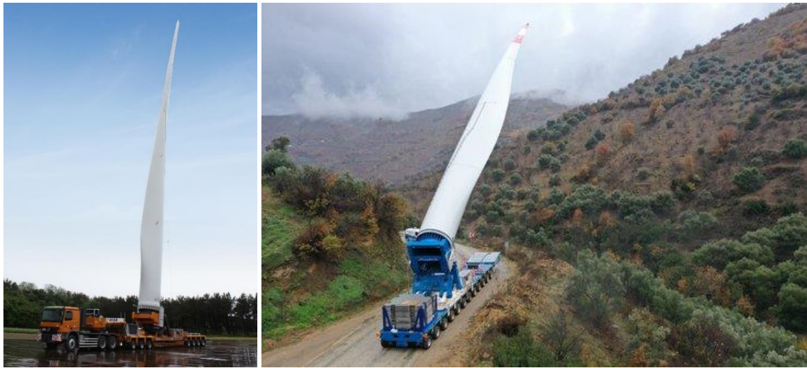
Figura 24 – Esempio di trasporto con Blade Lifter Trailer
