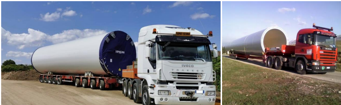
Figura 25 – Esempio di trasporto con convogli a pianale allungabile per conchi di torre
