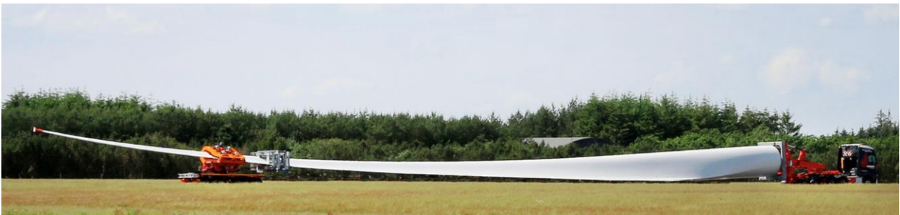
Figura 23 – Esempio di trasporto con "RBTS" (Rotor Blade Transport System)
