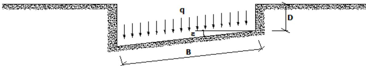
**Calcolo dei fattori di riduzione per rottura a punzonamento  $\psi_c$ ,  $\psi_q$ ,  $\psi_\gamma$**
