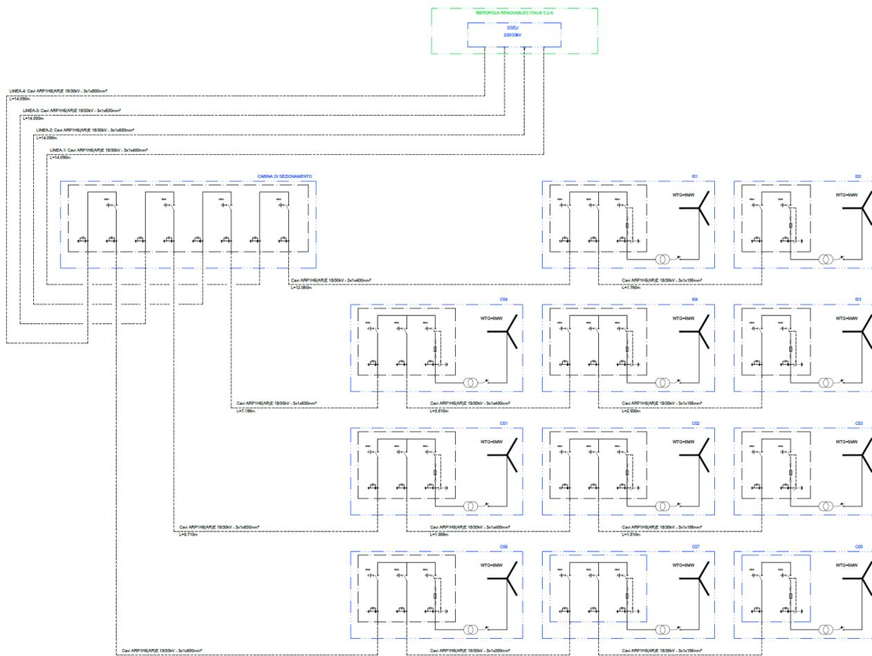
**Figura 12** Schema elettrico MT aerogeneratori di progetto
