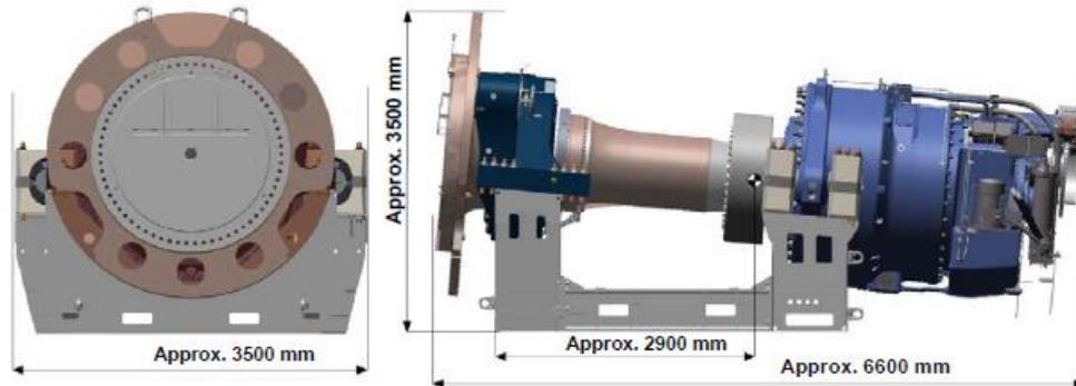
**Figura 9** Sistema di trasmissione del moto (Drive Train)
