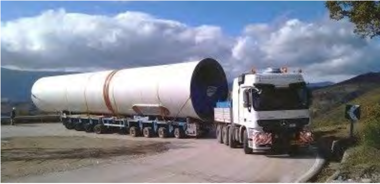
Figura 5 - Soluzione tipo del trasporto dei conici di torre con adeguamento in curva sulla viabilità esistente e del trasporto della navicella
