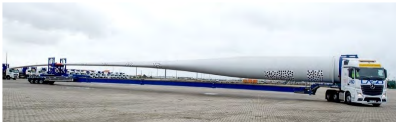
Figure 6 - Esempio di trasporto pale con tipologia SWC "Super Wing Carrier"
