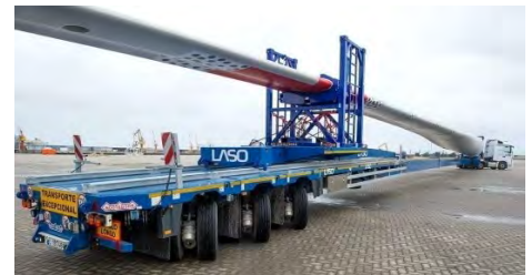
Figure 6 - Esempio di trasporto pale con tipologia SWC "Super Wing Carrier"
