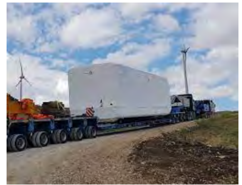
Figura 5 - Soluzione tipo del trasporto dei conici di torre con adeguamento in curva sulla viabilità esistente e del trasporto della navicella
