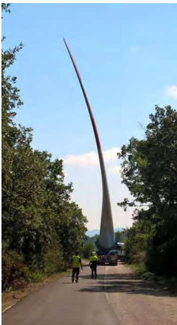
Figure 7 - Esempio di trasporto pale con tipologia "Blade Lifter Trailer"
