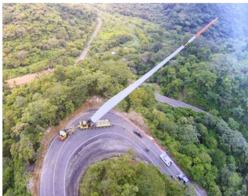
Figure 7 - Esempio di trasporto pale con tipologia "Blade Lifter Trailer"
