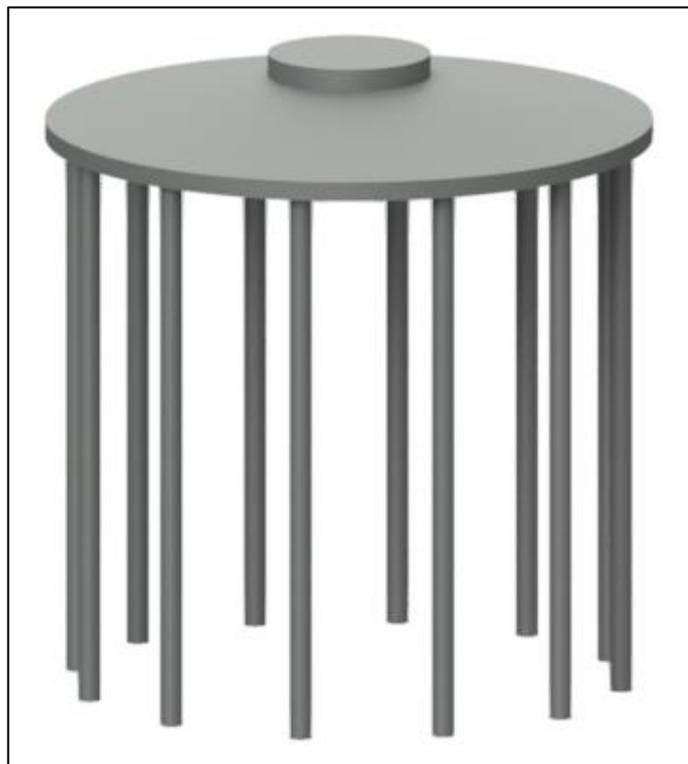
Figura 3: vista tridimensionale della fondazione dell'aerogeneratore
