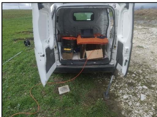
**Fotografia 23**-Sismografo PASI modello GEA24
