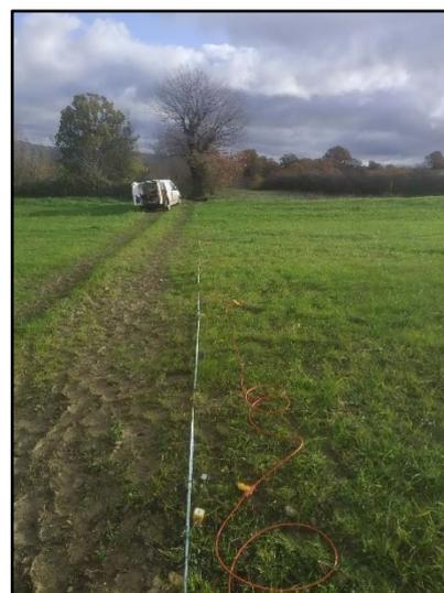
**Fotografia 2**-Visione verso Sud-Est dello stendimento sismico ST01
